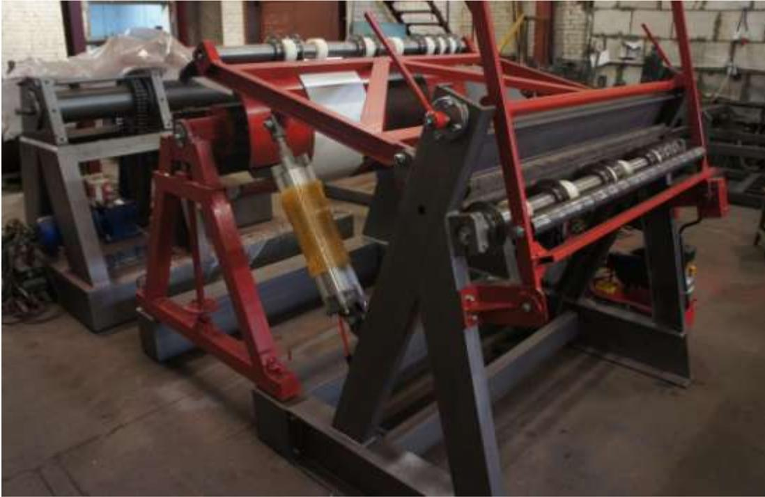
**Спецификация компактной универсальной линии продольно-поперечной резки рулонного металла толщиной от 0,4 мм до 0,7 мм/**
